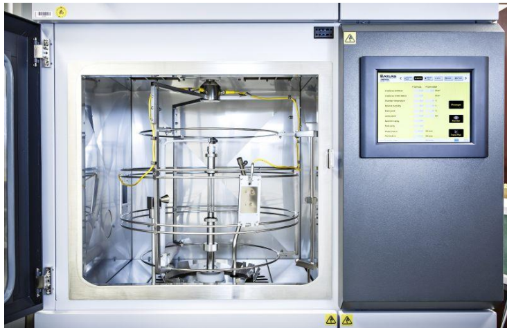
Laborbewitterung von Kunststoffbauteilen im Fraunhofer LBF. Foto: Fraunhofer LBF/Raapke
